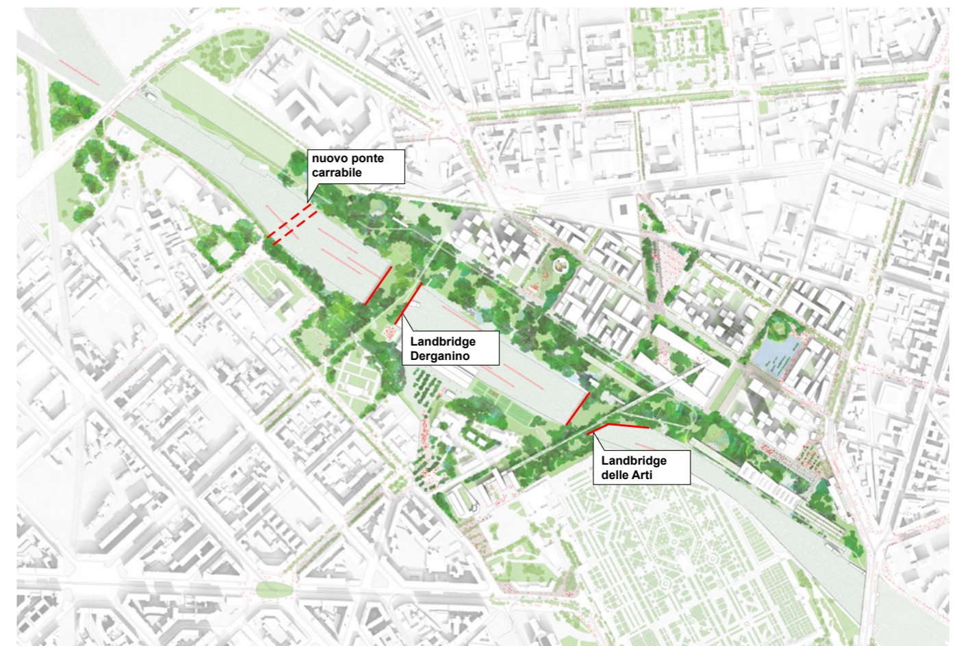
Schema delle nuove infrastrutture previste per superare la cesura del fascio ferroviario
